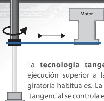
La **tecnología tangencial** garantiza una ejecución superior a las técnicas de cuchilla giratoria habituales. La dirección de la cuchilla tangencial se controla electrónicamente, con lo que las máquinas de la serie T son capaces de cortar de forma muy precisa a presiones muy altas. El corte perfecto hace que el pelado sea muy sencillo, ahorrándole un valioso tiempo.
