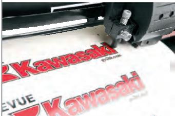
Las **ruedas tractoras y los tapones de alineación** cargan su vinilo derecho y lo mantienen en la posición correcta, incluso cortando a máxima velocidad.
